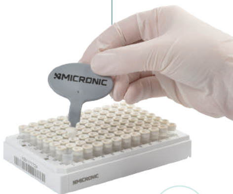
MANUELLER DECAPPER-1 Entfernt einzelne TPE-PushCaps
